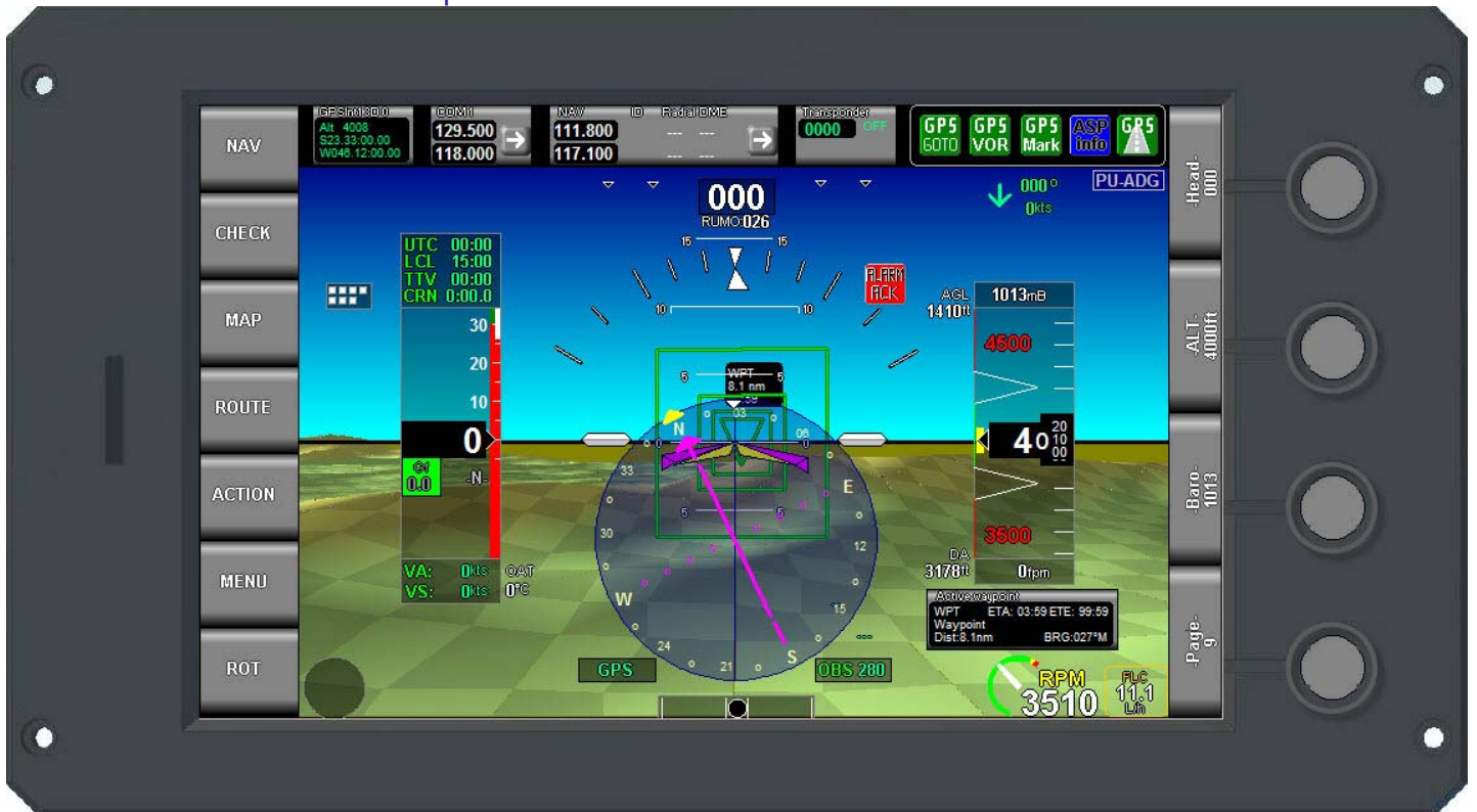
Exemplo de tela EFIS: horizonte com visão sintética
