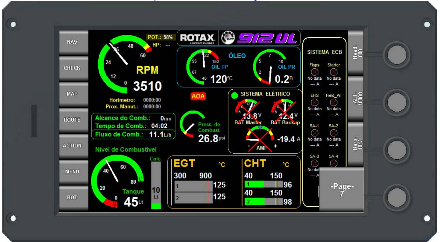
Exemplo de tela de monitoração de motor
