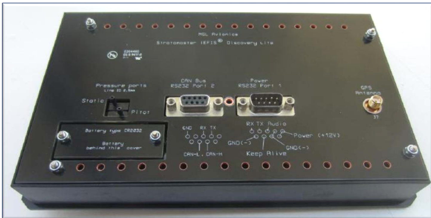
Interfaces no painel traseiro do sistema iEFIS Discovery Lite
